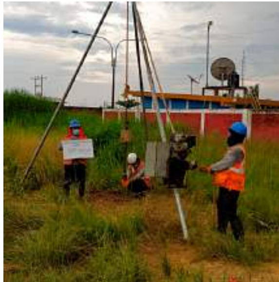
Figura 16. Ensayo de penetración estándar. De: (Basila, 2013)
