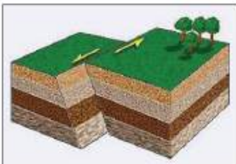
Figura 11. Falla transcurrente. De: (CHICAIZA, 2016)
